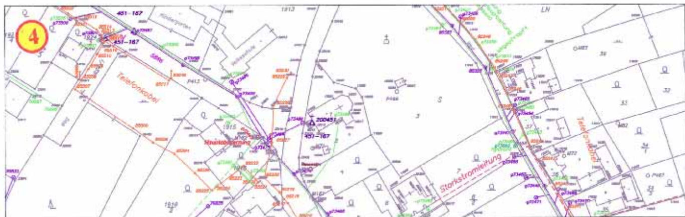
Telefonkabel , Wasserleitung , Kanal und Stromkabel dazugeschaltet
